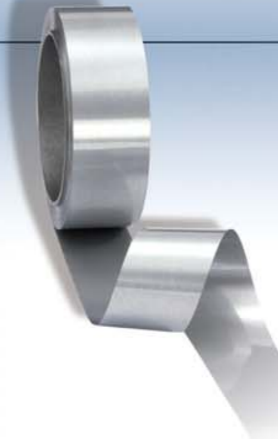
Schüttgut- und Bandbeschichtung: Für den Einsatz in Halogenlampen werden Bänder und Stifte beschichtet, um die Kontaktfähigkeit, Schweißbarkeit und Korrosionsbeständigkeit zu erhöhen. Typische Beschichtungsmaterialien sind alle Platingruppenmetalle.
